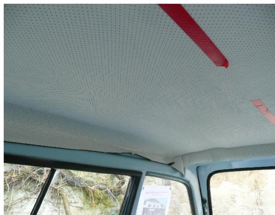
**Un inconvénient : du fait de l'épaisseur de la mousse, il se produit un pli là où débute la courbure du toit ... Je ne vais pas coller les bords, reposer la bordure, et laisser le temps estomper ce pli.**
